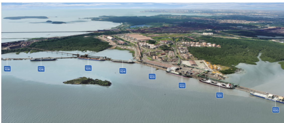
Figura 02 – Infraestruturas de acostagem do Porto do Itaqui, indicando a nomenclatura dos berços
